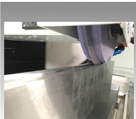
CNC abgerichtete Schleifscheibe
