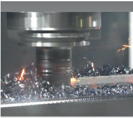
Fräsarbeit mit Hochvorschub
